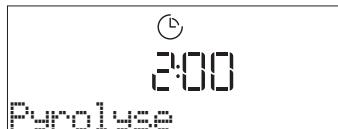
Drücken Sie + oder — zur Auswahl des ausgewählten Zyklus, dann drücken Sie ✓ zur Bestätigung. Nach Auswahl eines Zyklus, wenn gewünscht, + oder — drücken, um die Abschaltzeit (Startverzögerung) einzustellen, dann zur Bestätigung ✓ drücken.
