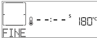
Premere ▶ per continuare la cottura in modalità manuale (senza timer) o premere + per prolungare il tempo di cottura impostando una nuova durata. In entrambi i casi, i parametri di cottura saranno mantenuti.
