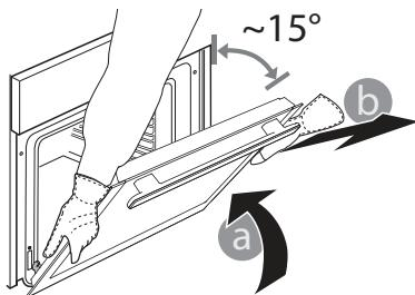
**3.** Montera tillbaka luckan genom att föra den mot ugnen och rikta in gångjärnens krokar med deras fästen. Säkra den övre delen i fästet.
