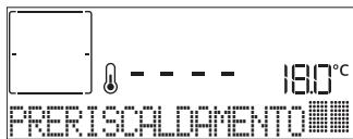
Al termine di questa fase, un segnale acustico e il display indicheranno che il forno ha raggiunto la temperatura impostata e comparirà la richiesta "AGG. ALIMENTO". A questo punto, aprire la porta, posizionare gli alimenti nel forno, chiudere la porta e avviare la cottura premendo ✓ o ▶.
