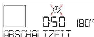
Drücken Sie oder zum Einstellen des gewünschten Garzeitendes, anschließend drücken Sie zur Bestätigung und zum Aktivieren der Funktion. Die Speise in den Ofen stellen und die Tür schließen: Die Funktion startet automatisch nach der berechneten Zeit, damit der Garvorgang zur eingestellten Zeit endet.
