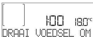
Een hoorbaar signaal gaat af en op het display verschijnt de uit te voeren actie. Open de deur, voer de actie uit die op het display staat, en sluit de deur, druk vervolgens op ▶ om de bereiding voort te zetten.
