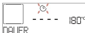
Wenn das Symbol auf dem Display blinkt, drücken Sie oder zum Einstellen der gewünschten Garzeit, und anschließend drücken Sie zur Bestätigung. Die Garzeit muss nicht eingestellt werden, wenn der Garvorgang manuell gehandhabt wird (ohne Timer): Drücken Sie oder zum Bestätigen und Starten der Funktion. Durch Auswahl dieses Modus können Sie keinen verzögerten Start programmieren.
