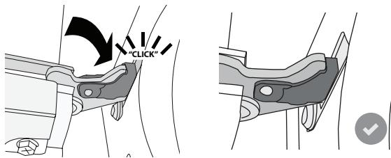
**5.** Forsøk å lukke døren for på påse at den står på linje med kontrollpanelet. Dersom den ikke gjør det, må trinnene ovenfor gjentas: Døren kan skades dersom den ikke lukker seg på riktig måte.
