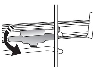
Varmista ohjain paikalleen painamalla pidikkeen alaosaa tiukasti hyllykköhjainta vasten. Varmista, että liukukappaleet liikkuvat vapaasti. Toista nämä vaiheet toiselle samalla tasolla olevalle kannattimelle.
