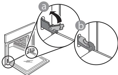
Udøv et let tryk, for at kontrollere at fæsteelementerne er i den korrekte position.
