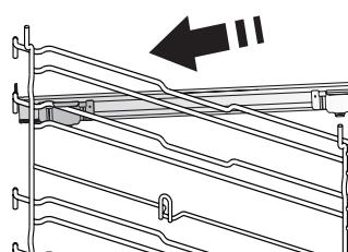
Die Seitengitter aus dem Ofen nehmen und den Kunststoffschutz von den Backauszügen entfernen.
