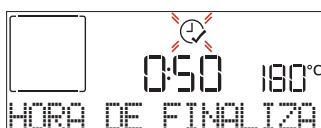
Pulse + o — para ajustar la hora a la que desea que finalice la cocción y, luego, pulse ✓ para confirmar y activar la función. Coloque los alimentos en el horno y cierre
