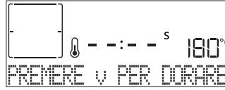
Quando il display visualizza il messaggio pertinente, se necessario, premere ✓ per avviare un ciclo di doratura di cinque minuti. Questa funzione può essere interrotta in qualsiasi momento premendo ⏹ per spegnere il forno.
