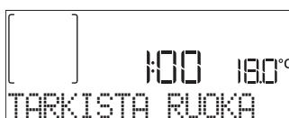
Tällöin kuuluu äänimerkki ja näytöllä näkyy suoritettava toimenpide. Tarkasta ruoka, sulje luukku ja jatka kypsentämistä painamalla ✓ tai ▶.
