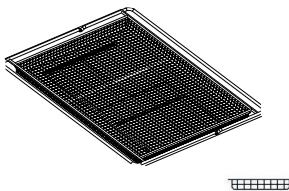
Anvendes til tilberedning af retter med funktionen Luftstegning, med en bradepande anbragt på et lavere niveau til opsamling af eventuelle krummer og dryp. Den kan vaskes i opvaskemaskinen.
