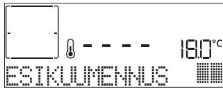
Kun tämä vaihe on päättynyt, kuuluu äänimerkki ja näyttö osoittaa, että uuni on saavuttanut asetetun lämpötilan; "LISÄÄ RUOKA". Avaa nyt luukku, aseta ruoka uuniin, sulje luukku ja aloita kypsennys painamalla ✓ tai ▶.
