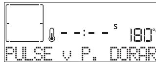
Cuando la pantalla lo indique, si lo desea pulse ✓ para iniciar un ciclo de gratinado de cinco minutos. Puede detener la función en cualquier momento pulsando ⏹ para apagar el horno.
