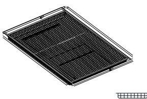
Používá se při přípravě pokrmů s funkcí Horkovzduš.smaž., kdy je pečicí plech umístěn na nižší úrovni, aby se zachytily případné drobky a kapky. Lze jej myt v myčce nádobí.
