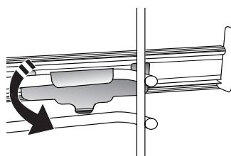
Aby byla vodicí mřížka dobře zajištěna, zatlačte pevně spodní část spony oproti vodicí mřížce. Ujistěte se, že drážkami lze volně pohybovat. Postupujte stejně i na druhé straně vodicí mřížky v rámci stejné výškové úrovně.
