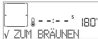
Wenn das Display die entsprechende Nachricht anzeigt, bei Bedarf  drücken, um einen fünfminütigen Bräunungszyklus zu starten. Die Funktion kann jederzeit durch Drücken von  gestoppt werden, um den Ofen auszuschalten.
