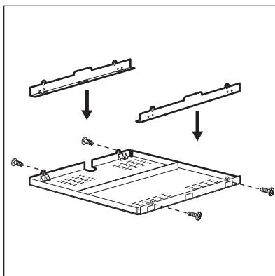
При использовании защитного экрана (приобретается отдельно) установка защитного пола непосредственно под варочную панелью не является обязательной. В ряде стран защитный экран может отсутствовать в списке доступных аксессуаров. Обратитесь к своему поставщику.
