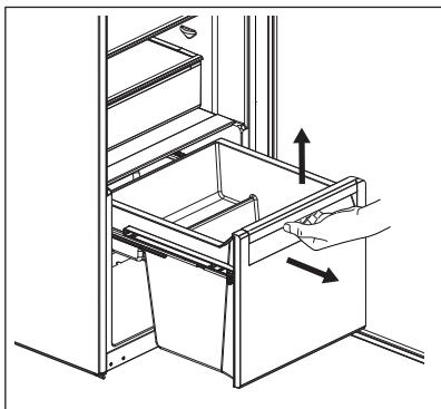
2. Schieben Sie die Schienen in das Gehäuse, um eine Beschädigung des Geräts beim Schließen der Tür zu verhindern.
