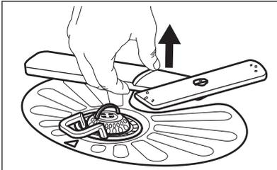
2. Reinigen Sie den Sprüharm unter fließendem Wasser. Entfernen Sie Verunreinigungen aus den Öffnungen des Sprüharms mit einem spitzen Gegenstand, z. B. einem Zahnstocher. Lassen Sie Wasser durch die Austrittsöffnungen laufen, um Verschmutzungen aus dem Inneren zu entfernen.
