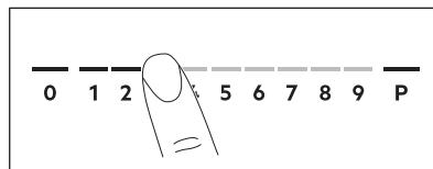
1. Appuyez sur le niveau de cuisson souhaité sur le bandeau de sélection. Vous pouvez également déplacer votre doigt le long du bandeau de sélection pour régler ou modifier le niveau de cuisson d'une zone de cuisson.
