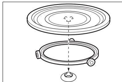
Gebruik alleen de draaitafelset die bij het apparaat werd meegeleverd. Bereid voedsel altijd op de draaiplateauset. Plaats de rolgeleider rond de draaischijfjas. Plaats het draaitafelglas op de rolleiding. Om de
